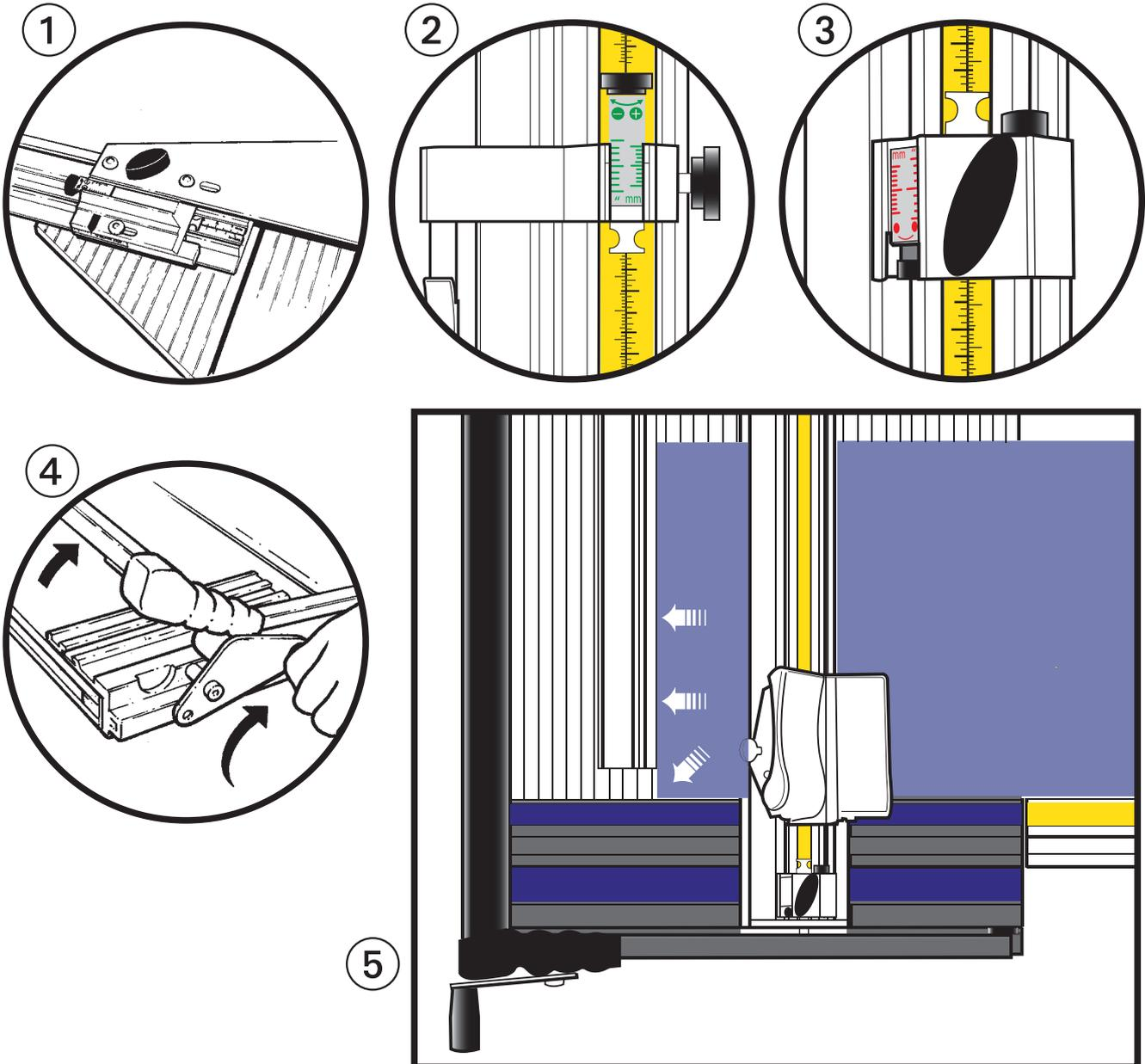
■ **DIE ANSCHLÄGE** auf dem ULTIMAT GOLD sind zur leichteren Erklärung nach Farben gekennzeichnet. **Zu diesem Zeitpunkt dürfen die Anschläge noch nicht verstellt werden.** Es dürfen allein die Anschläge mittels des großen schwarzen Flügelknopfs geändert werden. Die Einstellung des Positionsanzeigers wird später erklärt.
