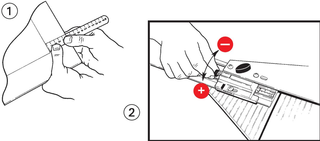
■ **DIE EINSTELLUNG DER ANSCHLÄGE** ist ein 2-Phasen-Vorgang, jedoch kann in den meisten Fällen die erste Phase ausgelassen werden.
