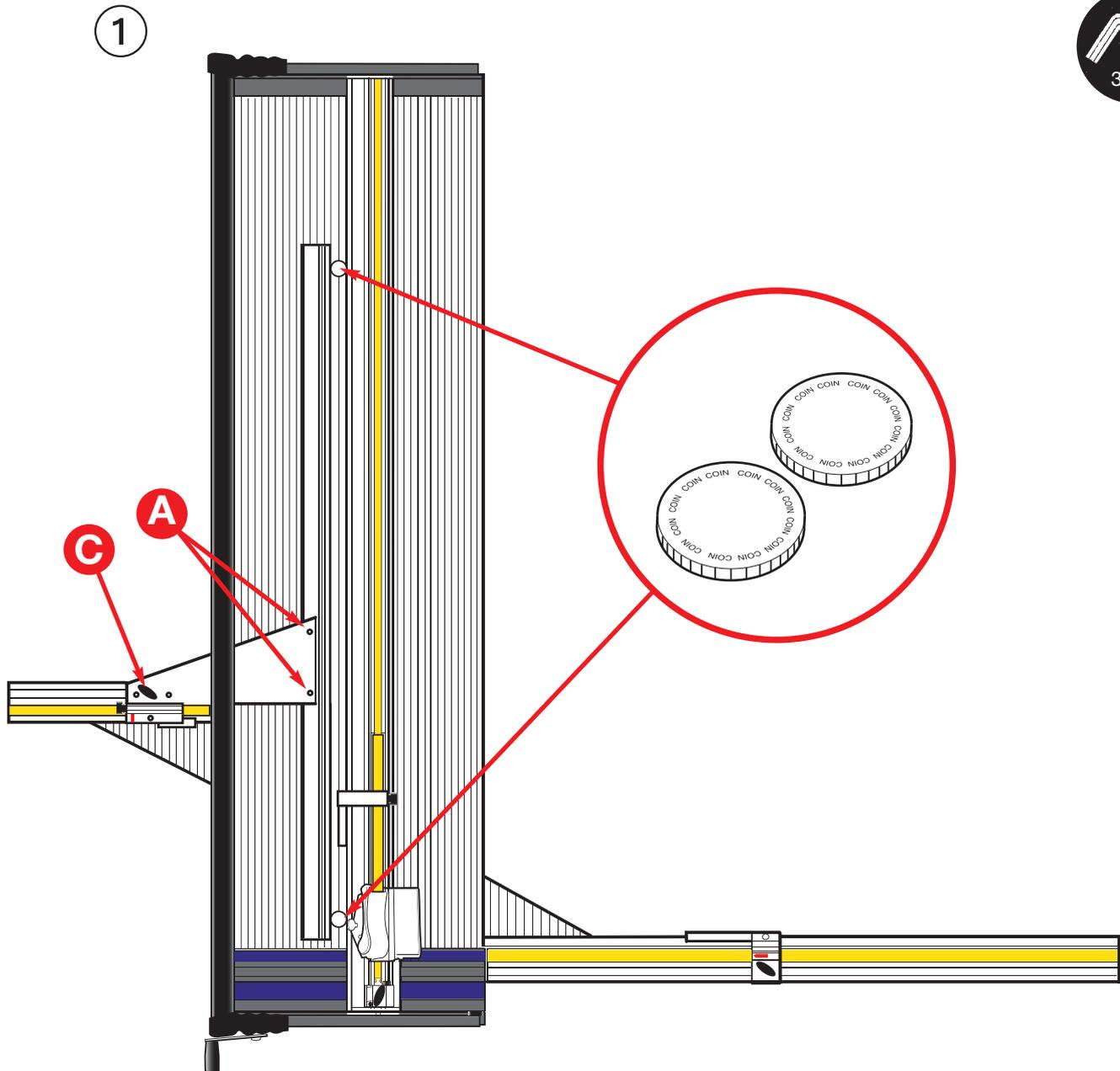
■ **DIE ABFLUCHUNG DER T-FÖRMIGEN STANGE DER PASSEPARTOUT-LEITSCHIENE** mit der Schneidezange wird mit Hilfe von zwei Münzen geprüft.
